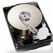
Dépôt de nickel sur disque dur permettant le stockage des données
